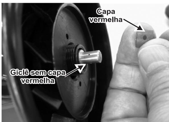
Posicione o furo do giclê coincidindo com o furo das capa vermelha. Consequentemente os outros 3 furos estarão automaticamente fechados.
