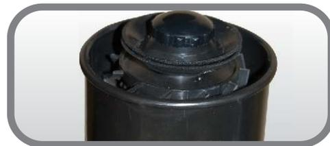
O bico UBV (ultra baixo volume) é um acessório auxiliar do atomizador, utilizado no combate de mosquitos transmissores da Dengue. Para que um bico UBV funcione com eficiência formando uma névoa fina, leve e quase invisível, é imprescindível que o líquido inseticida seja pressurizado por uma bomba centrífuga.
