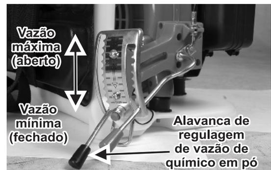
Se a vazão do pó não estiver atendendo as necessidades do trabalho ela poderá ser regulada reposicionando o tirante que movimenta a válvula de regulagem de vazão do pó, localizado entre o equipamento e o apoio para as costas.
