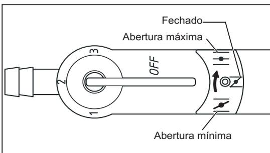
Regule a vazão girando a válvula localizada na ponta da mangueira transparente.
