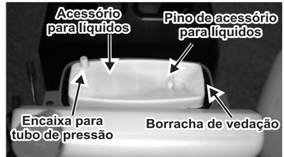
5- Recoloque o tanque de produtos químicos e aperte as porcas de fixação nas laterais do tanque.
