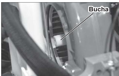
Quando for operar o equipamento com líquido novamente, será necessário reativar a bomba, recolocando a bucha. Sem ela, a água não sairá com pressão necessária para efetuar o trabalho de forma eficiente.
