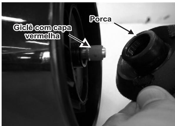
Retire a capa vermelha de cima dos furos do giclê e selecione a vazão desejada.
