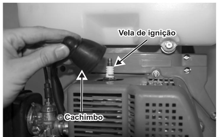
Se o eletrodo da vela de ignição estiver coberto de carvão, limpe-o com o auxílio de uma escova de aço (não utilize para isto lixa ou jato de areia, uma vez que os resíduos de areia da lixa ou do jato poderão se desprender e danificar o motor).
